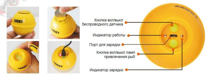
**3.2** Для включения беспроводного датчика нажмите кнопку вкл/выкл беспроводного датчика, загориться индикатор работы
