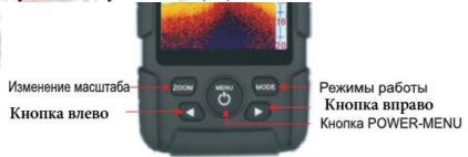
При включении прибора на экране появится стартовое меню «Запуск» позволяющее выбрать режим работы прибора в реальных условиях — в воде. Режим симулятора — Демо, имитирует работу прибора на воде и предназначен для демонстрации возможностей эхолота. Стартовое меню исчезнет через несколько секунд и прибор начнет работать.
