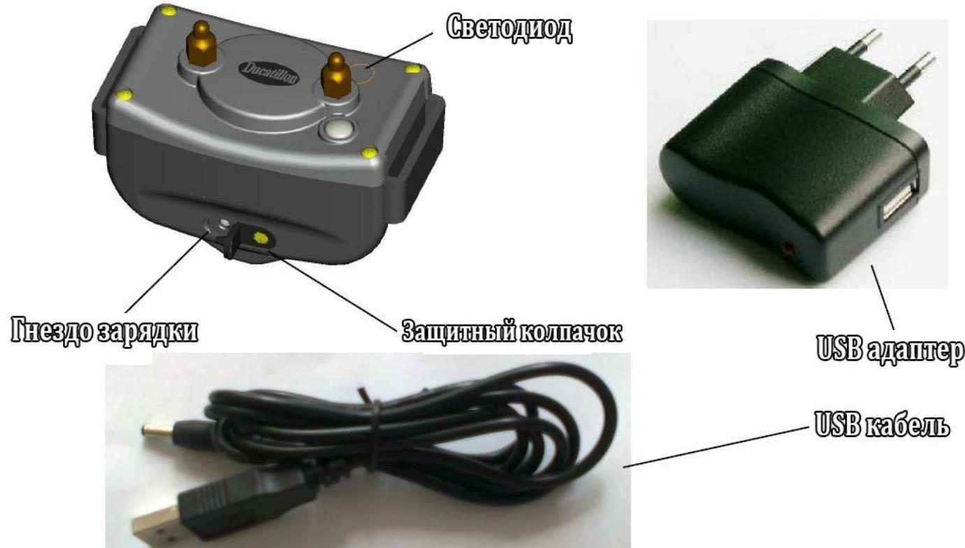
Ресивер Trainertec AE-10 заряжается в течение 2 часов. Откройте защитный колпачок и вставьте адаптер зарядки. Ресивер можно заряжать USB-кабелем только при подключении к питанию 5В постоянного тока.
